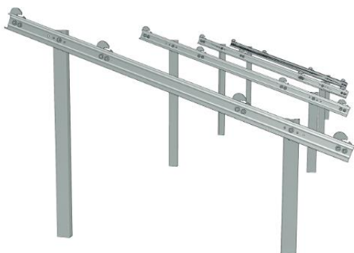
Figure 3 : Modèle de structure sans les modules
